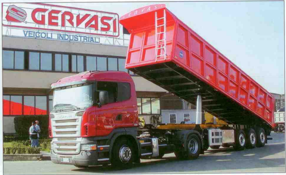
Naczepy wywrotki Hercules TDC 368 występują w dwóch pojemnościach skrzyni ładunkowej 43 i 48 m 3 . Uwagę zwraca zastosowanie siłownika podskrzyniowego
