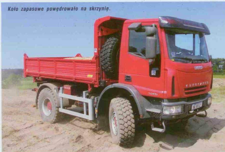
Choć wywrotka jest lekka, ma wysoką przednią ścianę chroniącą kabinę samochodu.
