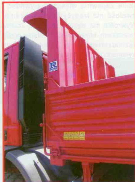
Choć wywrotka jest lekka, ma wysoką przednią ścianę chroniącą kabinę samochodu.
