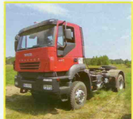
Ciągnik siodłowy Trakker 4x4 przeznaczony jest głównie do dostarczania na plac budowy ciężkiego sprzętu i materiałów budowlanych.
