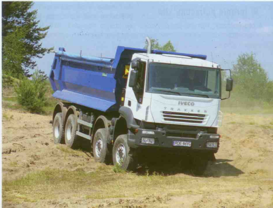
Trakker 8x8 w wersji ciężkiej z muldą tylnozsypową z firmy Skibicki.
