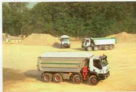
Wywrotki typu half-pipe mogą być zbudowane ze stali lub aluminium. Warto zwrócić uwagę na oryginalny system rozpinania plandeki.
